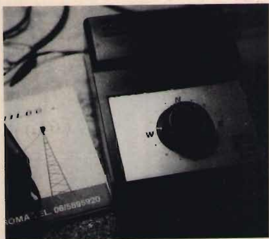
Il quadro di comando del rotore WISI-MR12.
